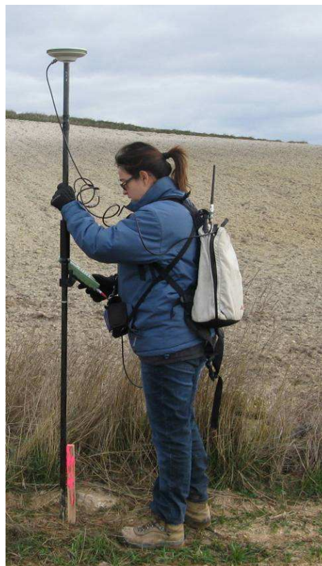
Figura 7. Medición de la superficie de referencia con equipo RTK
